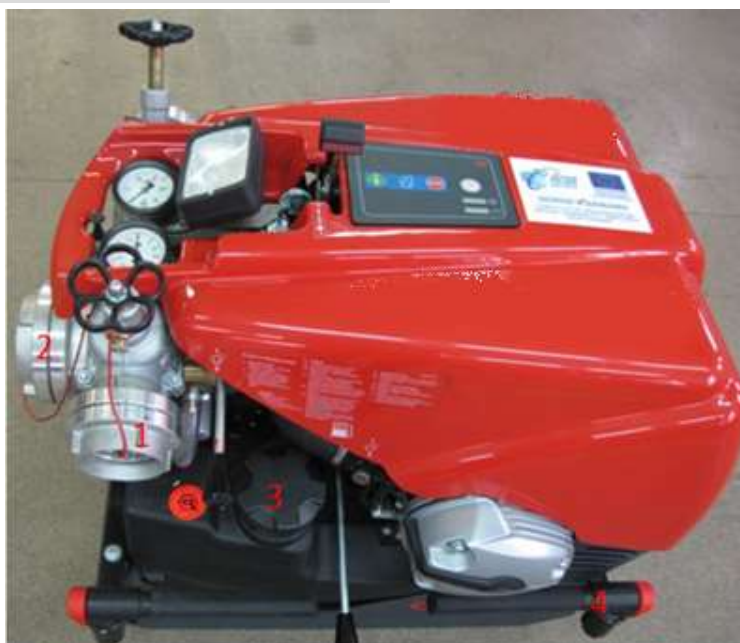
1 – króciec wlotowy (ssawny), 2 – króciec wylotowy (tłoczny), 3 – zbiornik paliwa, 4 – uchwytu do przenoszenia
