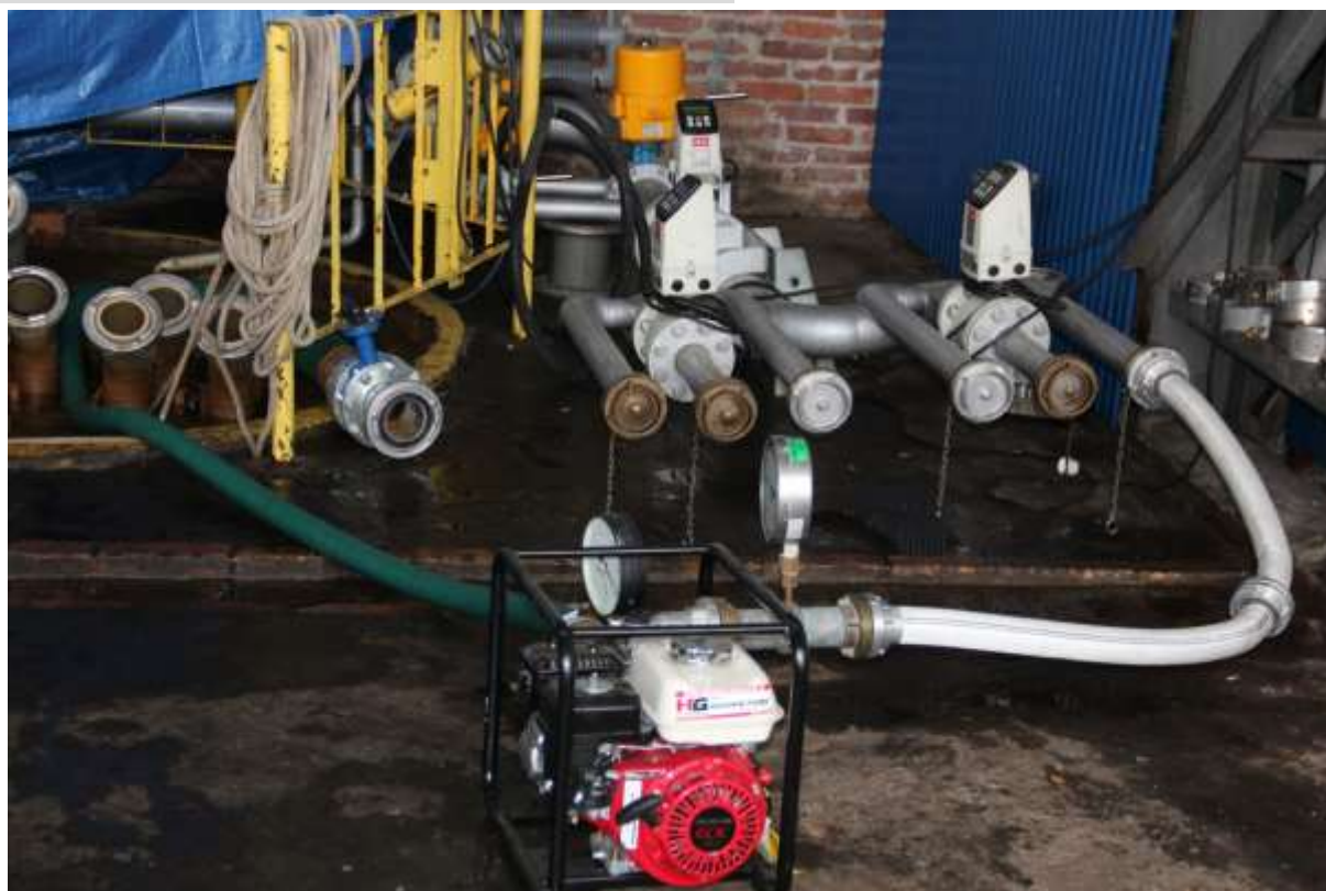
Ryc. 8. Stanowisko badawcze dla motopomp przewoźnych lub przenośnych Źródło: Archiwum CNBOP-PIB.
