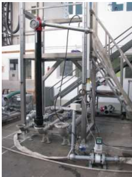
Ryc. 3. Badanie natężenia przepływu i współczynnika K_v hydrantu zewnętrznego
