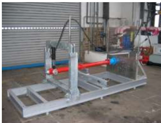
Ryc. 4. Badanie odporności hydrantu zewnętrznego
