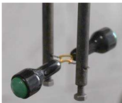
Ryc. 3. Zapłoniki pirotechniczne (5kJ każdy) zamocowane na elektrodach
