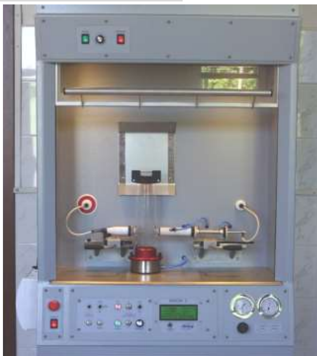
Ryc. 8. Stanowisko do badania minimalnej energii zapłonu wg normy PN-EN 13821:2004
