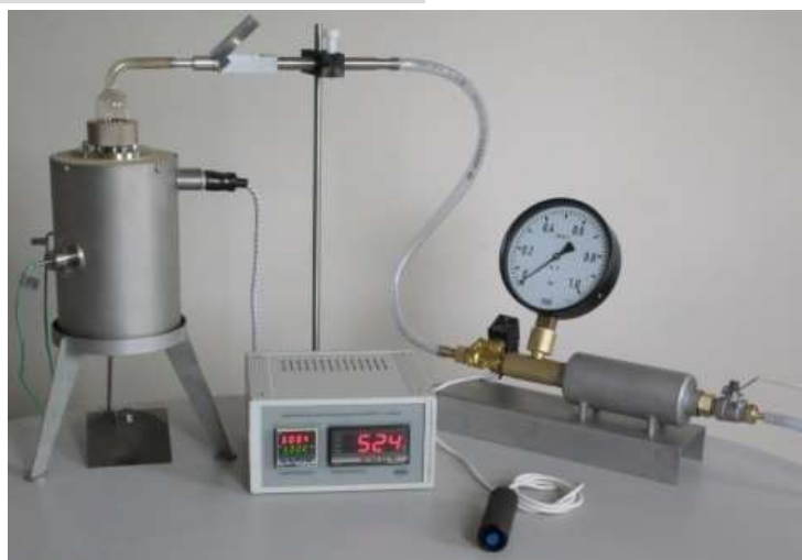
Ryc. 11. Aparatura do oznaczania minimalnej temperatury zapłonu obłoku pyłu w piecu o stałej temperaturze
