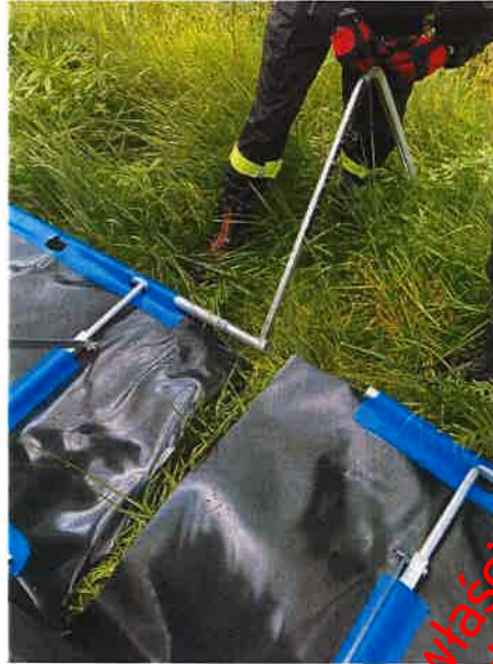
Fot. 7 łączenie podstawowych elementów stelażowych ze sobą
