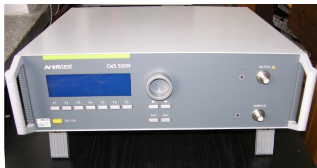
Ryc. 9. Wyposażenie do badania odporności na zaburzenia przewodzone indukowane przez pola elektromagnetyczne Źródło: archiwum Zespołu Laboratoriów BA
