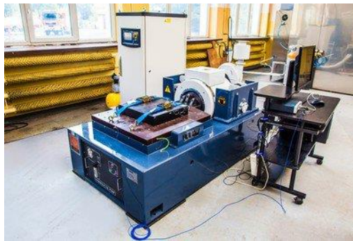
Ryc. 5. Widok stołu wibracyjnego Źródło: archiwum Zespołu Laboratoriów BA
