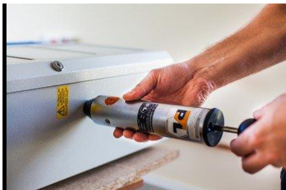
Ryc. 4. Widok młota sprężynowego Źródło: archiwum Zespołu Laboratoriów BA
