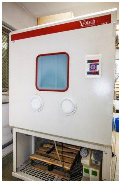
Ryc. 3. Widok komory do badań klimatycznych Źródło: archiwum Zespołu Laboratoriów BA
