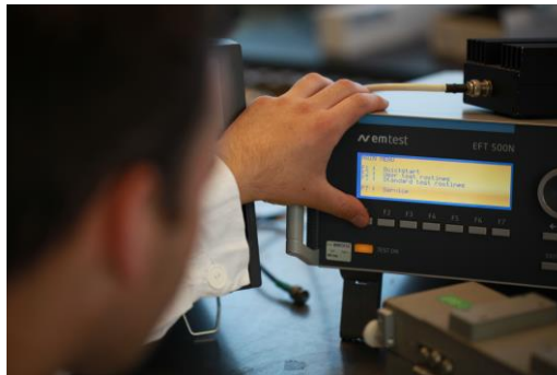
Ryc. 10. Wyposażenie do badania odporności na serie elektrycznych stanów przejściowych Źródło: archiwum Zespołu Laboratoriów BA
