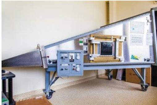
Ryc. 8. Wyposażenie do badania odporności na wypromieniowane pola elektromagnetyczne Źródło: archiwum Zespołu Laboratoriów BA
