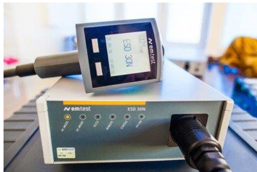
Ryc. 7. Wyposażenie do badania odporności na wyładowania elektrostatyczne Źródło: archiwum Zespołu Laboratoriów BA
