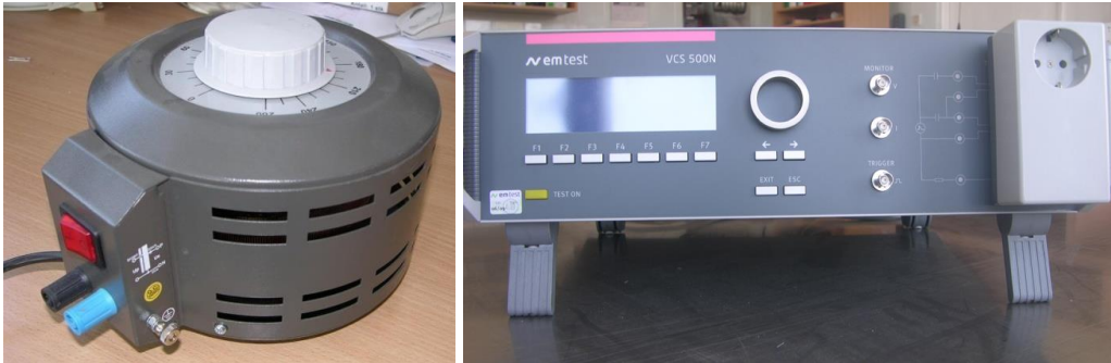
Ryc. 6. Wyposażenie do badania odporności na zapady i zaniki napięcia sieciowego Źródło: archiwum Zespołu Laboratoriów BA
