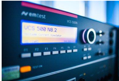
Ryc. 11. Wyposażenie do badania odporności na powolny udar napięciowy o wysokiej energii Źródło: archiwum Zespołu Laboratoriów BA
