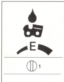
Rysunek nr 5.10. Przykładowe oznaczenie na korpusie piły śruby regulacyjnej wydajności pompy oleju
