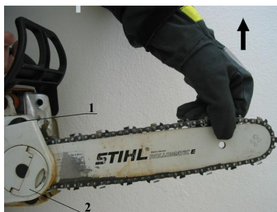
Fotografia nr 5.4. Prawidłowe napięcie łańcucha tnącego
