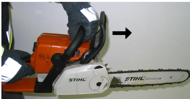
Fotografia nr 5.2. Uruchamianie hamulca łańcucha
