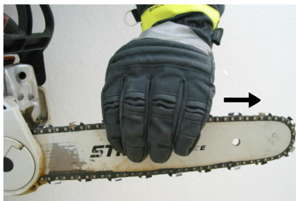
Fotografia nr 5.5. Sprawdzanie płynności ruchu łańcucha tnącego
