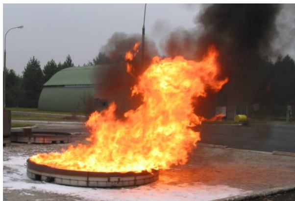
Fotografia nr 2.2. Pożar testowy (pożar cieczy wylanej na tacę)
