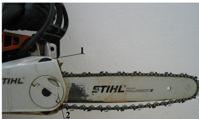
Fotografia nr 5.3. Niewłaściwe napięcie łańcucha tnącego
