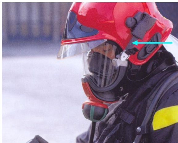
Fotografia nr 4.8. Mocowanie maski bezpośrednio do hełmu
