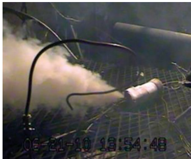
Ryc. 45. Wyciek gazów/oparów podczas niestabilności termicznej ogniwa cylindrycznego
