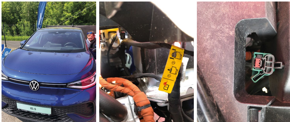
Ryc. 34. Oznaczenie wyłącznika awaryjnego układu WN w VW ID.5, umieszczonego pod pokrywą silnika, w przedniej części pojazdu
