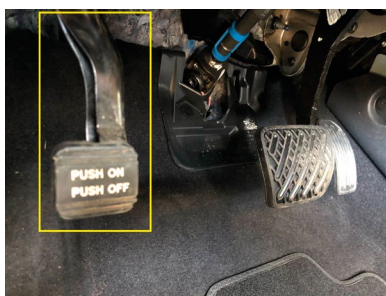
Ryc. 25. Hamulec ręczny uruchamiany za pomocą nogi
