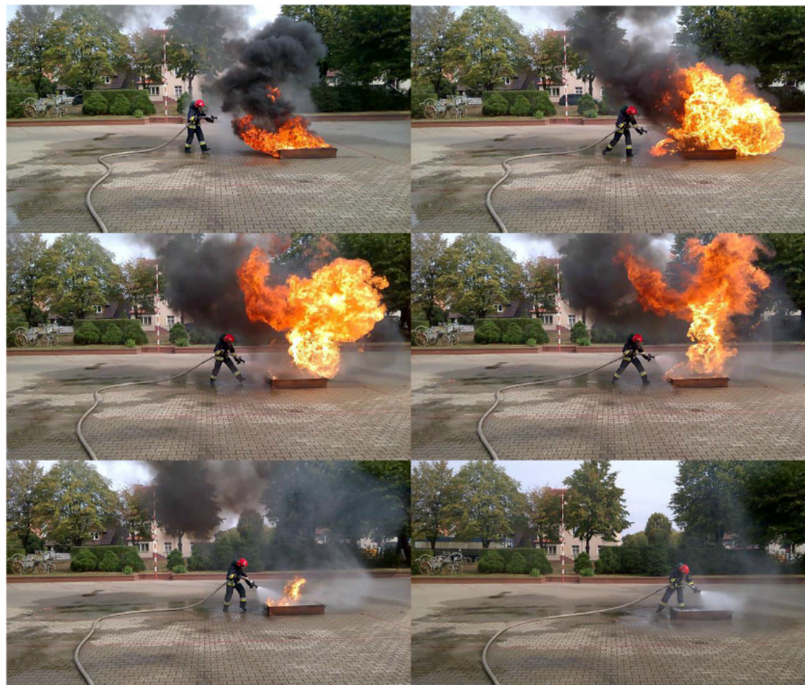
Fot. 4-9 Gaszenie pożaru cieczy palnej prądownicą GunPro M3, Prądownica podłączona do linii gaśniczej 52, ciśnienie robocze 6 bar
