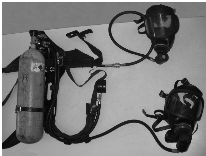
Fot. nr 105 Przykładowy systemy aparatu z dodatkową maską ewakuacyjną
