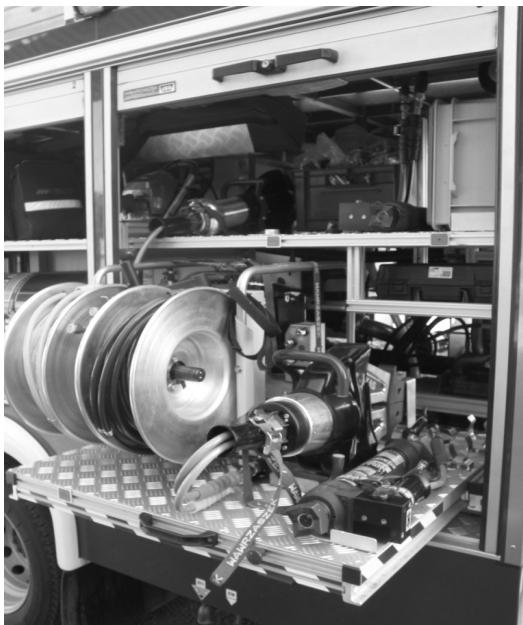
Fot. nr 60. Przykładowe rozmieszczenie ratowniczego zestawu hydraulicznego
