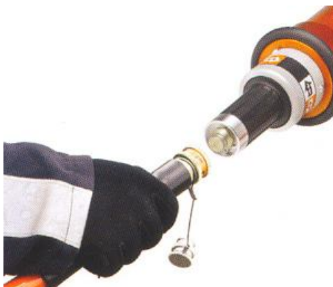
Fot. nr 59. Przykładowy sposób łączenia przewodu z narzędziem w systemie jednowężowym
