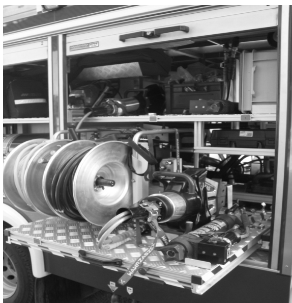
Fot. nr 77. Przykładowe rozmieszczenie ratowniczego zestawu hydraulicznego
