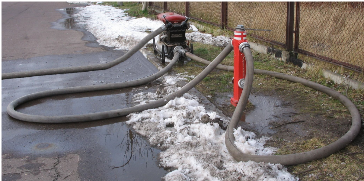
Fot. nr 7. Zasilanie strony ssawnej motopompy bezpośrednio z hydrantu przez zbieracz
