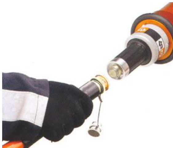
Fot. nr 76. Przykładowy sposób łączenia przewodu z narzędziem w systemie jednowężowym
