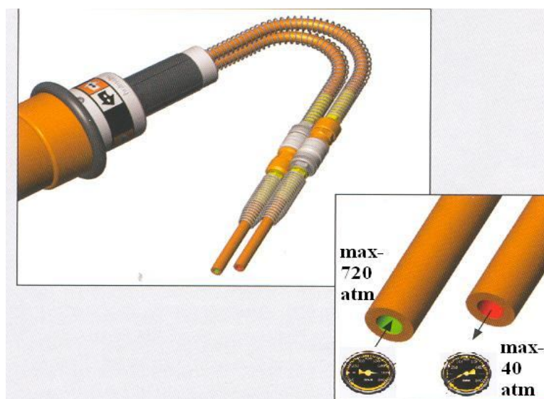
Fot. nr 22. Kierunki przepływu cieczy roboczej
