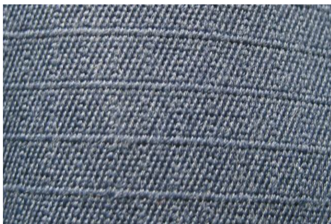
Fot. nr 145 Struktura „rip stop”
