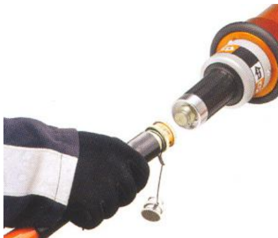
Fot. nr 29. Przykładowy sposób łączenia przewodu z narzędziem w systemie jednowężowym
