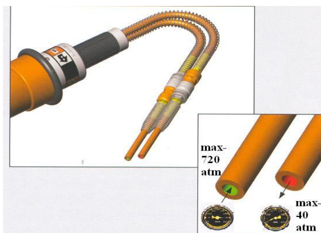
Fot. nr 71. Kierunki przepływu cieczy roboczej
