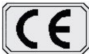
Rysunek nr 38. Oznaczenie CE, które musi posiadać agregat prądotwórczy oraz wszystkie inne urządzenia elektryczne
