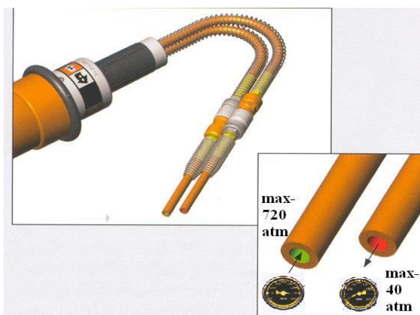
Fot. nr 54. Kierunki przepływu cieczy roboczej
