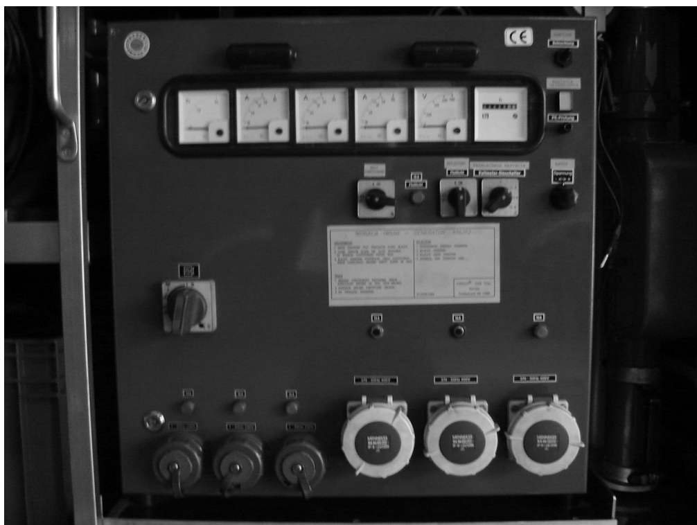
Fot. nr 90. Przykładowy panel obsługowo kontrolny agregatu zamontowanego na stałe w samochodzie pożarniczym
