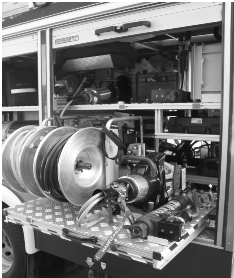
Fot. nr 30. Przykładowe rozmieszczenie ratowniczego zestawu hydraulicznego
