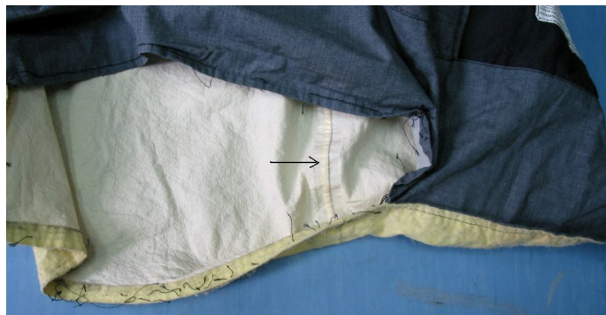
Fot. nr 147 Przykładowe miejsce klejenia membrany połączonej z włókniną termoizolacyjną
