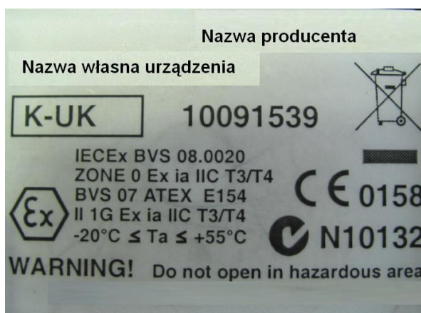
Fot. 138 Przykładowa tabliczka znamionowa sygnalizatora bezruchu
