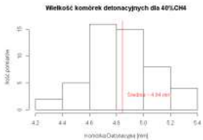
Rysunek 61 Charakterystyczne wielkości komórek detonacyjnych dla mieszaniny 40%CH4 w tlenie.
