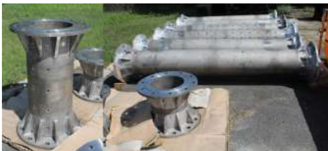
Rysunek 11 Rzeczywiste elementy układu rury detonacyjnej – widoczne kolnierze służące do łączenia elementów i gwintowane otwory/gniazda na czujniki
