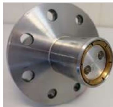
Rysunek 206 Widok powierzchni czujnika ciśnienia dynamicznego, mający na który oddziałuje fala ciśnienia
