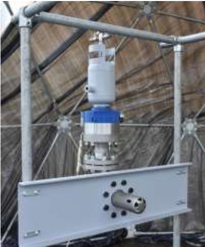
Rysunek 131 Butla zamontowana na stelażu w namiocie badawczym
