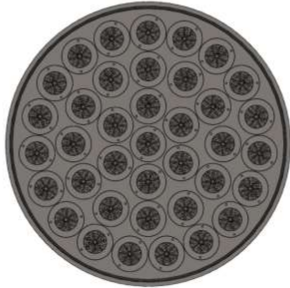
Rysunek 91 Widok od frontu na cylinder z 38 wkładami tłumiącymi
