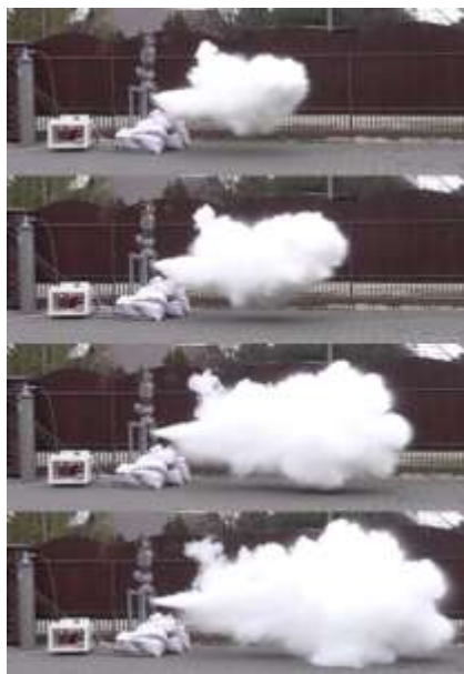
Rysunek 135 Rozproszenie strugi proszku gaśniczego bez dyszy (od góry) 25, 30, 40, 50 ms
