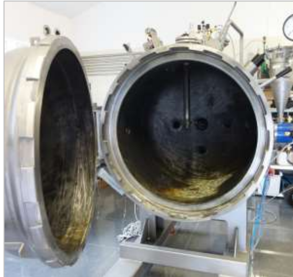
Rysunek 186 Widok komory pyłowej przy otwartej pokrywie (widoczny układ mocowania zapłonu)
