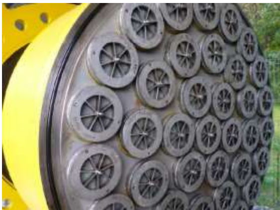
Rysunek 99 Widok na wkłady tłumiące od strony oddziaływania frontu spalania detonacyjnego
