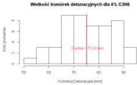
Rysunek 64 Charakterystyczne wielkości komórek detonacyjnych dla mieszanki 4% C3H8 i powietrza
