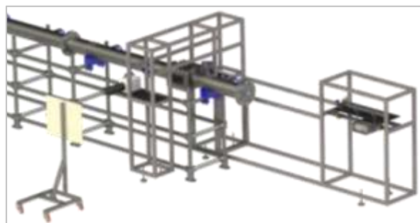
Rysunek 200 Układu do wizualizacji frontu fali typu Shadowgraph
