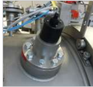
Rysunek 193 Sposób mocowania czujnika ciśnienia dynamicznego
