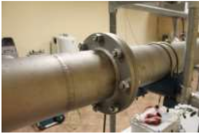
Rysunek 2 Fragment kołnierza oraz sposobu mocowania rury do ramy nośnej
