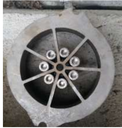
Rysunek 102 Widok na kołpak ochrony pojedynczego wkładu tłumiącego znajdujący się od strony niechronionej. Widoczne na pierwszym planie system dociskowy.
