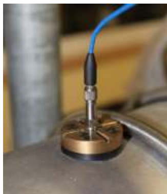
Rysunek 5 Sposób mocowania czujnika umożliwiający zminimalizowanie wpływu drgań
