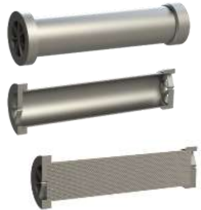
Rysunek 204 Wkłady tłumika (widok ogólny, przekrój, rys. 3D)
