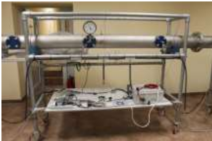
Rysunek 3 Układ rury detonacyjnej przymocowany do systemu nośnego wg technologii Kee-Klamp
