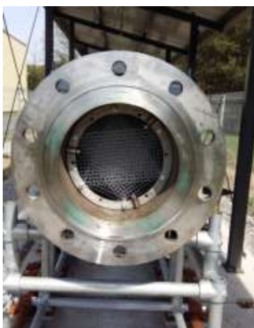
Rysunek 103 Widok z góry na zbudowaną sekcję przeszkody o długości 1 m
