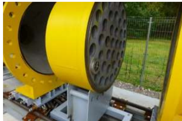
Rysunek 100 Widok na rozdzielony prototyp, widoczne wolne miejsca służące do umieszczenia w nich wkładów tłumiących
