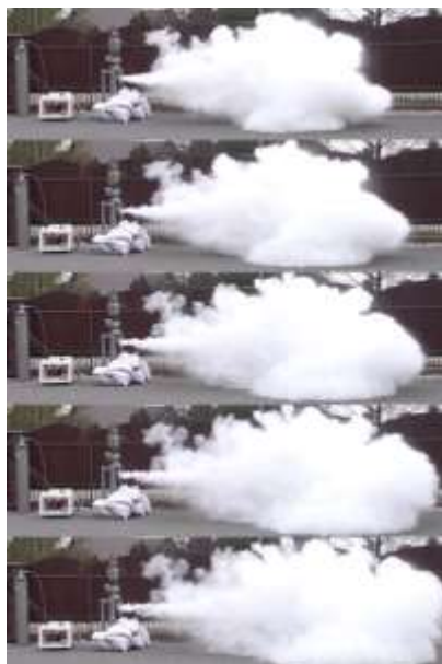
Rysunek 136 Rozproszenie strugi proszku gaśniczego bez dyszy (od góry) 60, 70, 80, 90, 100 ms
