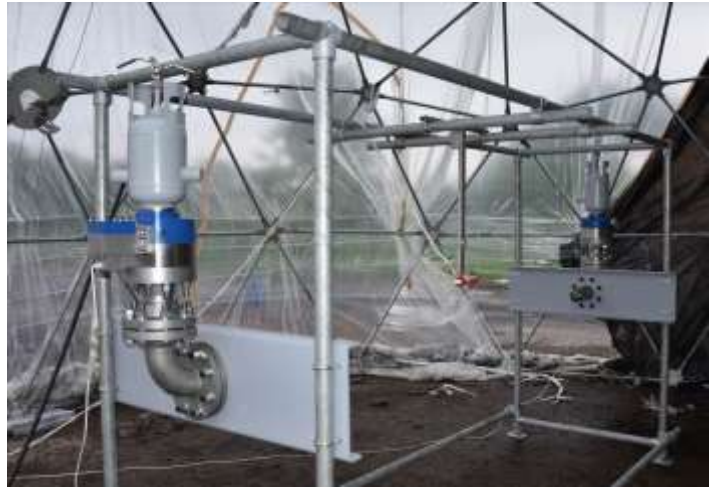
Rysunek 132 Butle zamontowane na stelażu w namiocie badawczym
